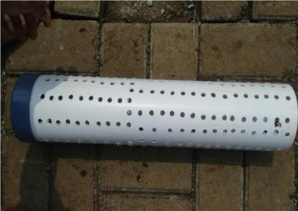
**Gambar 2.** Pipa Paralon yang sudah di lubangi
