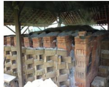
Gambar 4. Proses pembakaran batu bata
