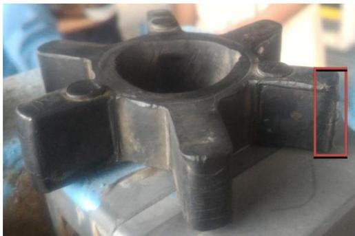
Gambar 13. Kerusakan Pada *Rubber Coupling*
