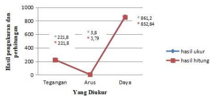
Gambar 17. Grafik Hasil ukur dan Nameplate untuk merek Model 3
