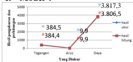
Gambar 14. Grafik Hasil ukur dan Nameplate untuk merek Model 4
