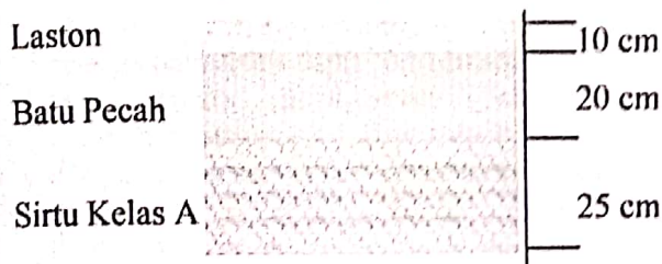
Gambar 5. Struktur Tebal Lapisan Perkerasan
