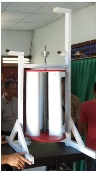
Gambar 2. Perangkat Turbin Savonius
