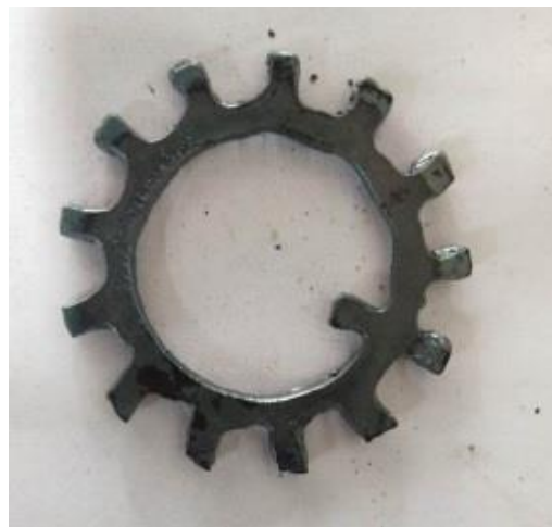
Gambar 9. Hasil pemotongan Mesin CNC Plasma Cutting .
