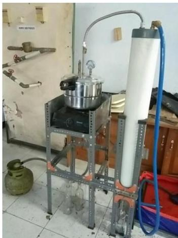
Gambar 3. Alat Distilasi Uap Air
